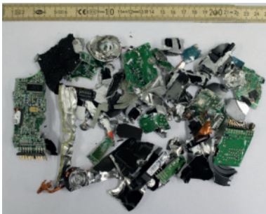
Piezas externas de la carcasa metálica de los discos duros: H-3
